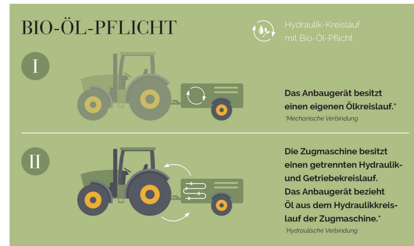
Abbildung 1: Übersicht zur Verwendung von Bio-Hydraulik-Öl in forstlichen Anbaugeräten © PEFC Bayern
